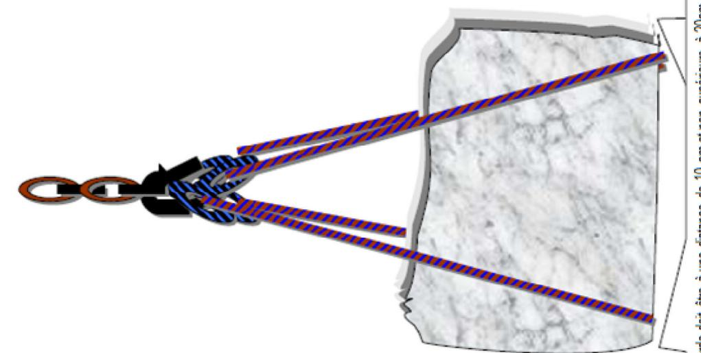
**OUI** : La corde doit être à une distance de 10 cm et non supérieure à 20cm du bord de la plaque
